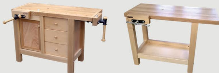
Nos établis sont en **hêtre massif** étuvé et **verniss**. Les plateaux sont constitués de plusieurs éléments collés par joints dentés puis liés aux 2 extrémités par 2 embouts rainurés, collés et vissés pour former un **ensemble très robuste**. Les piétements de **forte section** sont assemblés, collés par tenons-mortaises, et offrent **une grande stabilité**.
